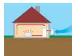
Tepelné čerpadlo vzduch-voda
